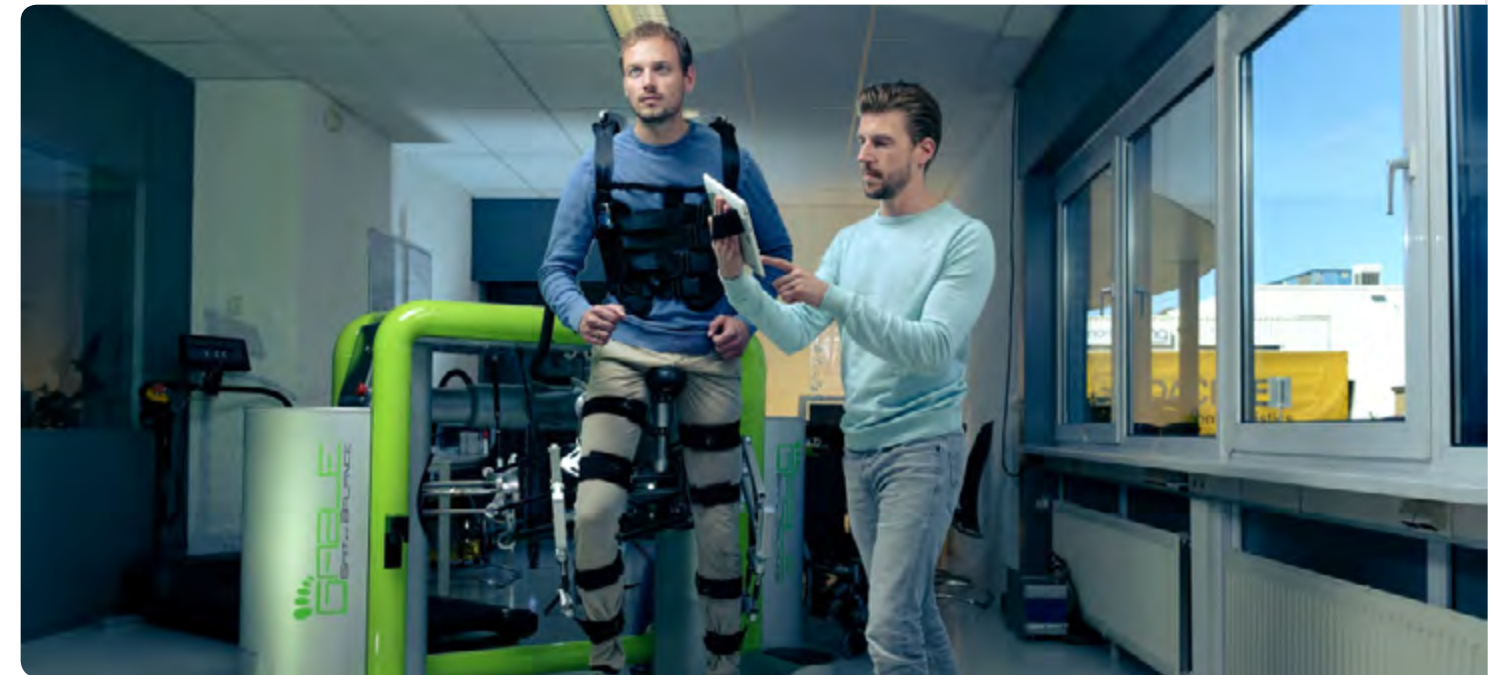
Looprobot LOPES II bij het Roessingh
